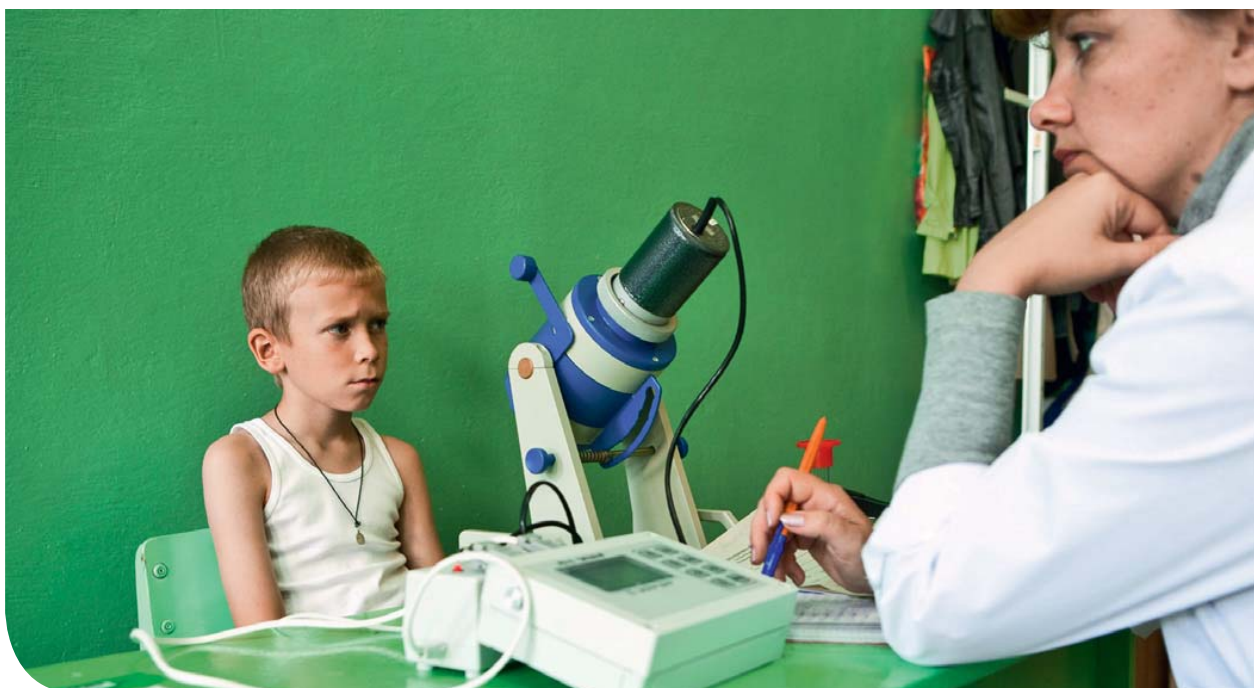
Mesure de la concentration corporelle en césium 137 dans le cadre d'un programme de recherche dédié à l'étude des conséquences de la contamination chronique par le césium.
