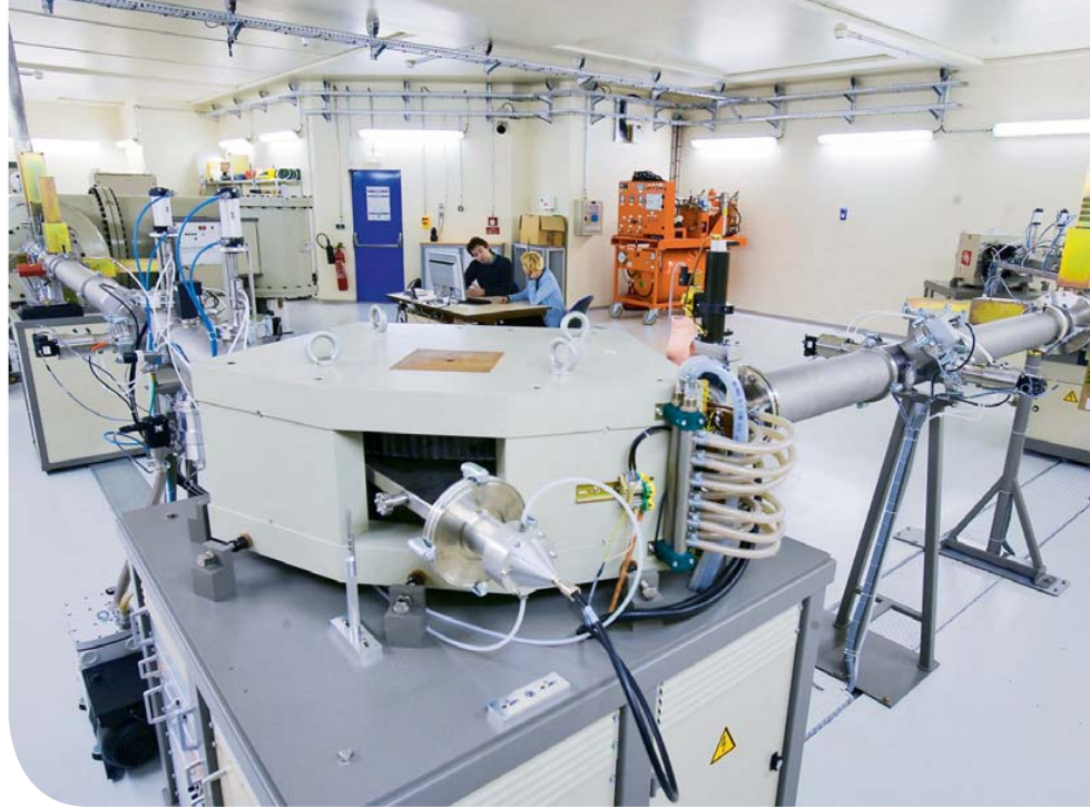
L'installation AMANDE, à Cadarache (Bouches-du-Rhône) fournit des références métrologiques pour la dosimétrie des neutrons.
