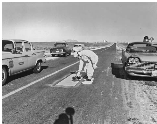
Figure 8.2. Mesure de la contamination des sols au voisinage du réacteur SL-1. © INL.
