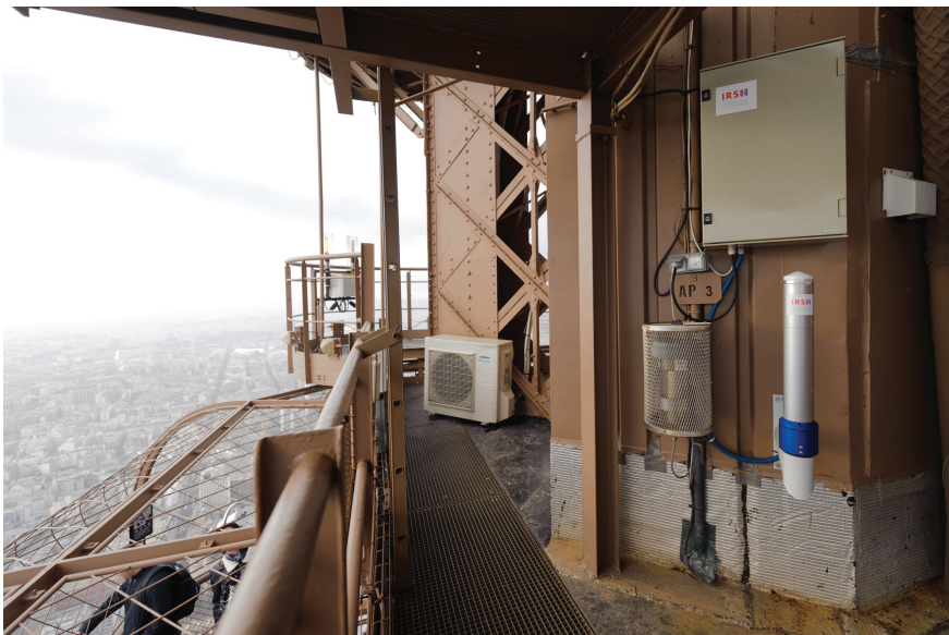
Figure 38.2. Sonde Téléray installée à la Tour Eiffel à Paris. Arnaud Bouissou/MEDDE/Médiathèque IRSN.
