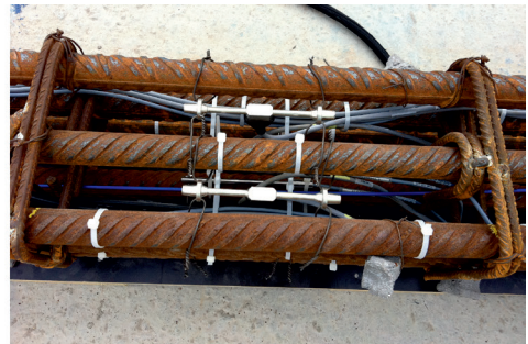
Figure 27.16. À gauche, schéma de principe d'un dispositif à corde vibrante. SFEN; à droite vue de deux extensomètres installés au sein d'un réseau d'armatures de génie civil, avant le coulage du béton. EDF.
