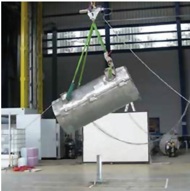
Figure 11.2. Essai de chute sur un poinçon (barre verticale) d'une maquette d'emballage DN30 de Daher-NCS (colis de type B). ASN.
