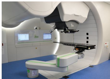
Centre Antoine Lacassagne de Nice. La tête rotative isocentrique compacte (appelée Gantry) permet d'orienter le faisceau d'irradiation selon différentes incidences autour du patient. © Centre Antoine Lacassagne
