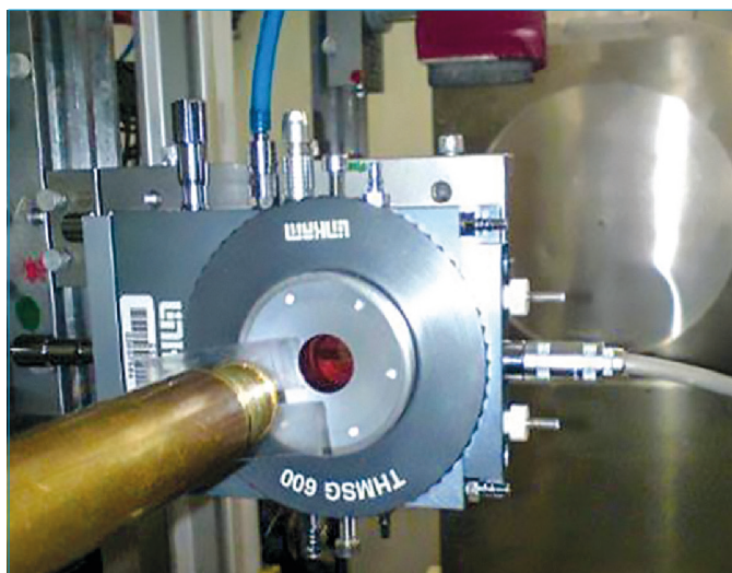
Dispositif expérimental sur la ligne de lumière Id15 à l'ESRF. Le faisceau de rayon X incident vient traverser l'échantillon avant de frapper le détecteur. Les anneaux de diffractions obtenus permettent d'identifier les caractéristiques cristallographiques de l'échantillon.
