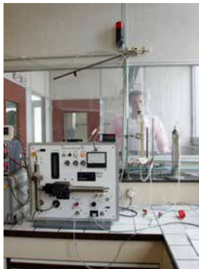
Banc d'essais EPI. Essais avec gant et tenue étanche non ventilée (TENV). Photos : LECEV. Gauche : essais avec tenue étanche ventilée (TEV). Photo : O. Seignette, M. Lafontan/Médiathèque IRSN.
