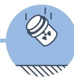
**Chute de 9 m** sur une surface indéformable ou **test d'écrasement** par une plaque en acier de 500 kg chutant d'une hauteur de 9 m
