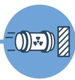
**Impact à grande vitesse** : sur une cible rigide à 90 m/s (324 km/h)
