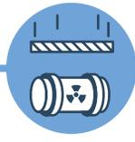
**Écrasement** : chute libre d'une masse de 500 kg, d'une hauteur de 9 m (plaque en acier de 1 x 1 m tombant en position horizontale)
