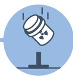
**Chute de 1 m sur un poinçon en acier**
