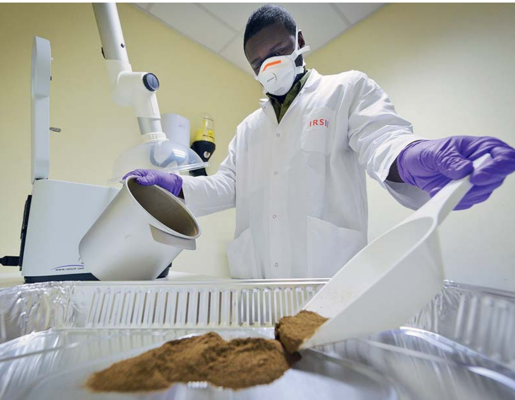
Pour mesurer la radioactivité, les échantillons prélevés doivent être préparés. Ici, l'étape de broyage.
