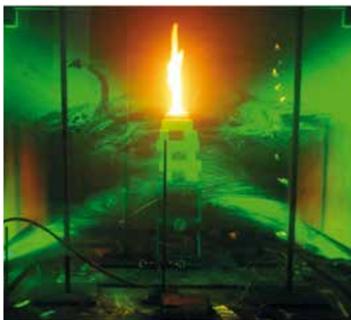
Figure 1 : Feu de nappe situé à 40 cm de haut.
