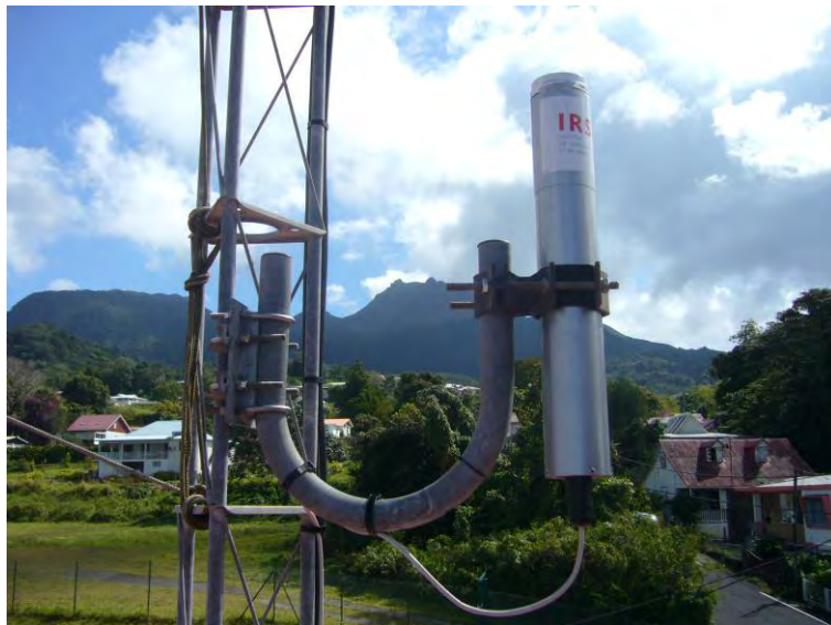
Figure 2 - Sonde Teleray installée en Guadeloupe (photo Gendarmerie nationale).
