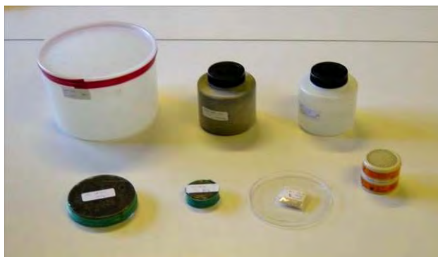
Figure 12 - Géométries de mesure par spectrométrie gamma couramment utilisées pour la surveillance de la radioactivité de l'environnement.
