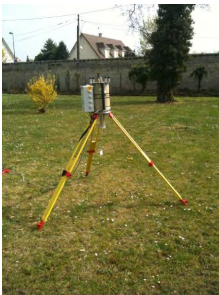
Figure 39 - Spectromètre Germanium Hannibal.
