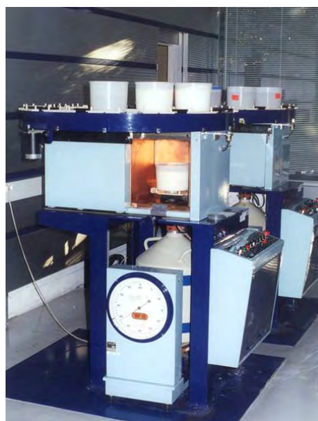
Figure 10 - Chaînes de mesure par spectrométrie gamma équipées de passeurs automatiques d'échantillons (Laboratoire de mesure nucléaire au Vésinet).
