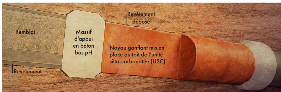
Schéma d'un scellement de descenderie dans Cigéo d'après l'Andra (dossier de DAC - 2023)
