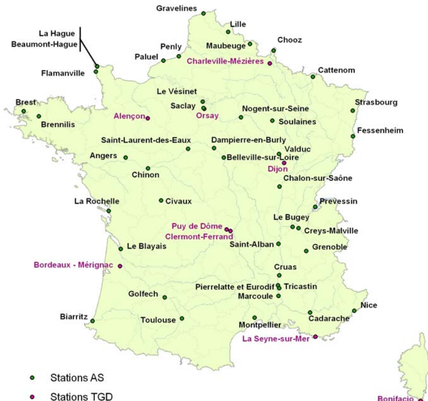
Implantation des stations de prélèvement d'aérosols du réseau OPERA-Air de l'IRSN (en 2009). En violet, les stations à grand débit de prélèvement (TGD) pour les études et recherches sur la contamination radioactive de l'air ; en noir, les stations de prélèvement quotidien pour la surveillance régulière de l'air (AS).
