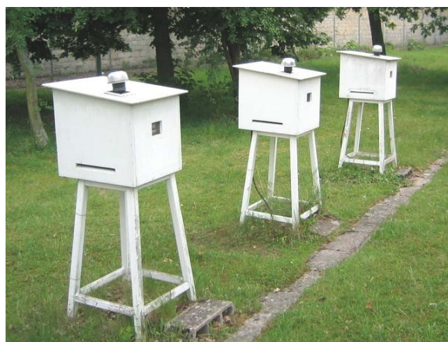
Réseau OPERA-Air de l'IRSN : stations de collecte d'aérosols (AS) pour la surveillance régulière de la radioactivité de l'air (site du Vésinet)
