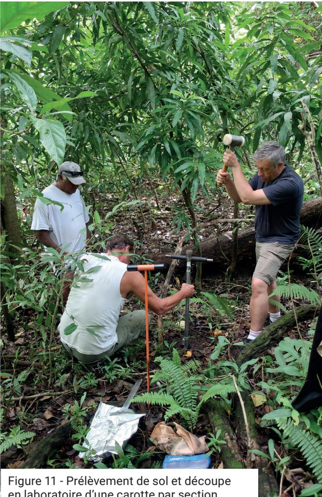
Figure 11 - Prélèvement de sol et découpe en laboratoire d'une carotte par section.
