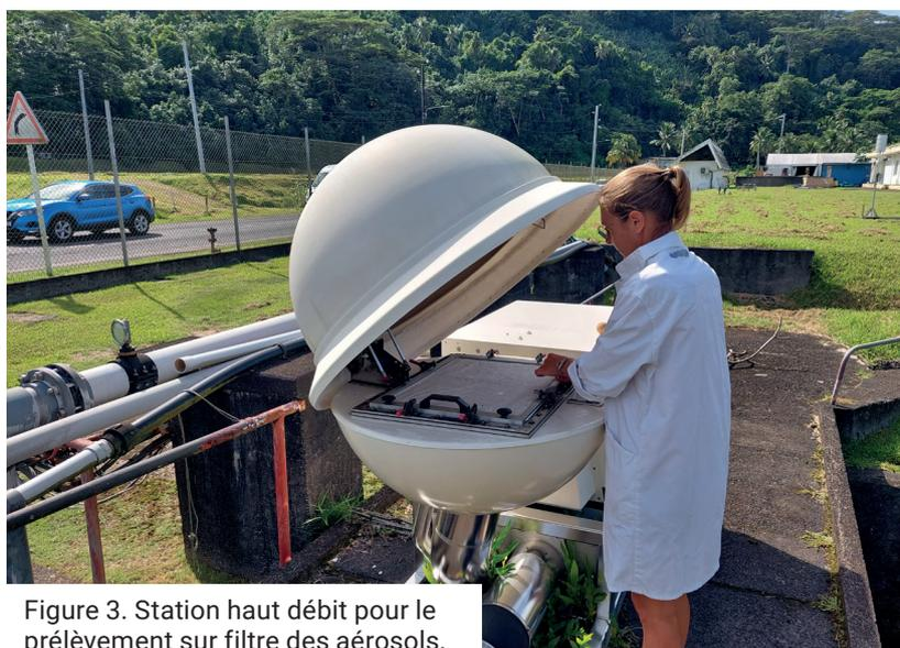
Figure 3. Station haut débit pour le prélèvement sur filtre des aérosols.
