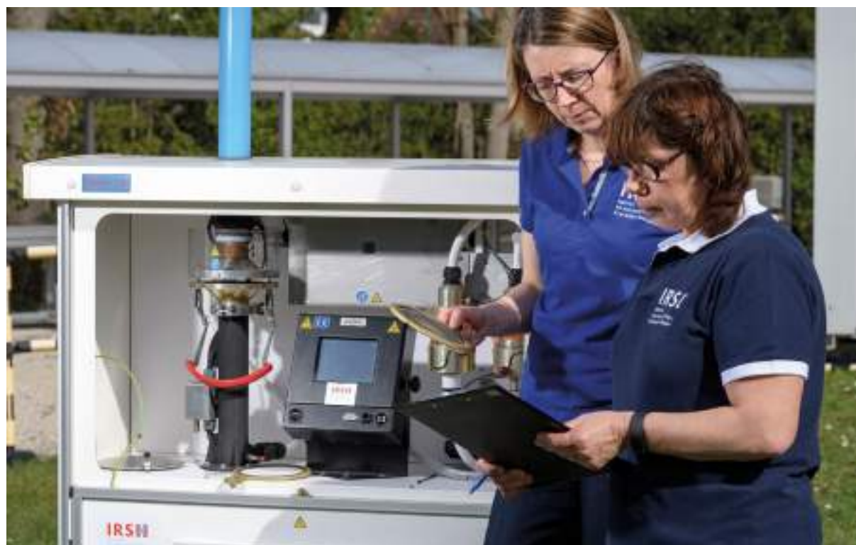
FIGURE 5 / CHANGEMENT DU FILTRE SUR UNE STATION OPÉRA
