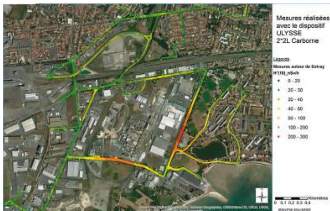
FIGURE 7 / DÉBITS D'ÉQUIVALENT DE DOSE RELEVÉS À L'AIDE DU DISPOSITIF DE SPECTROMÉTRIE GAMMA ROUTIER (le rayonnement cosmique n'est pas pris en compte par ce dispositif de mesure - chapitre 1)
