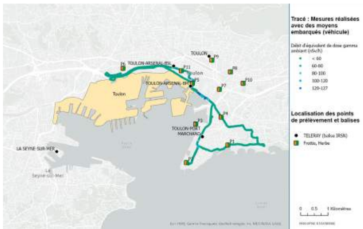
FIGURE 2 / CARTOGRAPHIE DU DÉBIT D'ÉQUIVALENT DE DOSE GAMMA AMBIANT ET LOCALISATION DES POINTS DE PRÉLÈVEMENT AUX ABORDS DE LA BASE NAVALE DE TOULON (septembre 2022)
