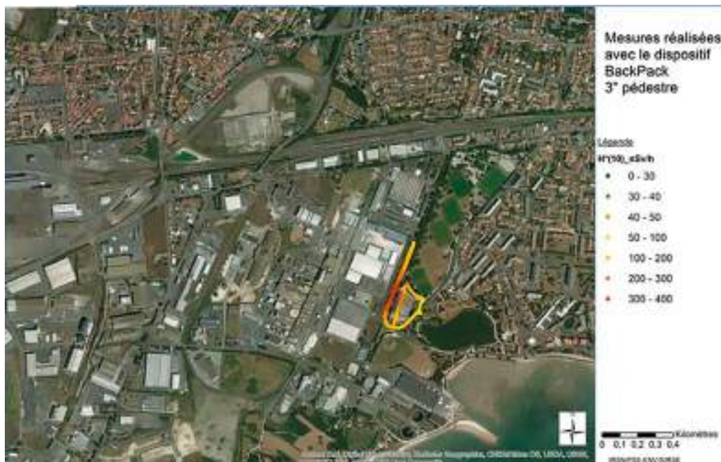
FIGURE 8 / DÉBITS D'ÉQUIVALENT DE DOSE RELEVÉS À L'AIDE DU DISPOSITIF DE SPECTROMÉTRIE GAMMA « SAC À DOS » (mode pédestre) (le rayonnement cosmique n'est pas pris en compte par ce dispositif de mesure - chapitre 1)
