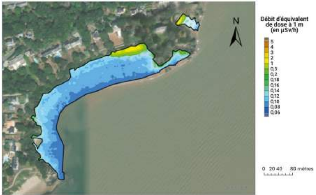
FIGURE 4 / CARTOGRAPHIE DU DÉBIT D'ÉQUIVALENT DE DOSE MESURÉ À UN MÈTRE DU SOL SUR LES PLAGES DE TRÉBÉZY ET AUX ALENTOURS
