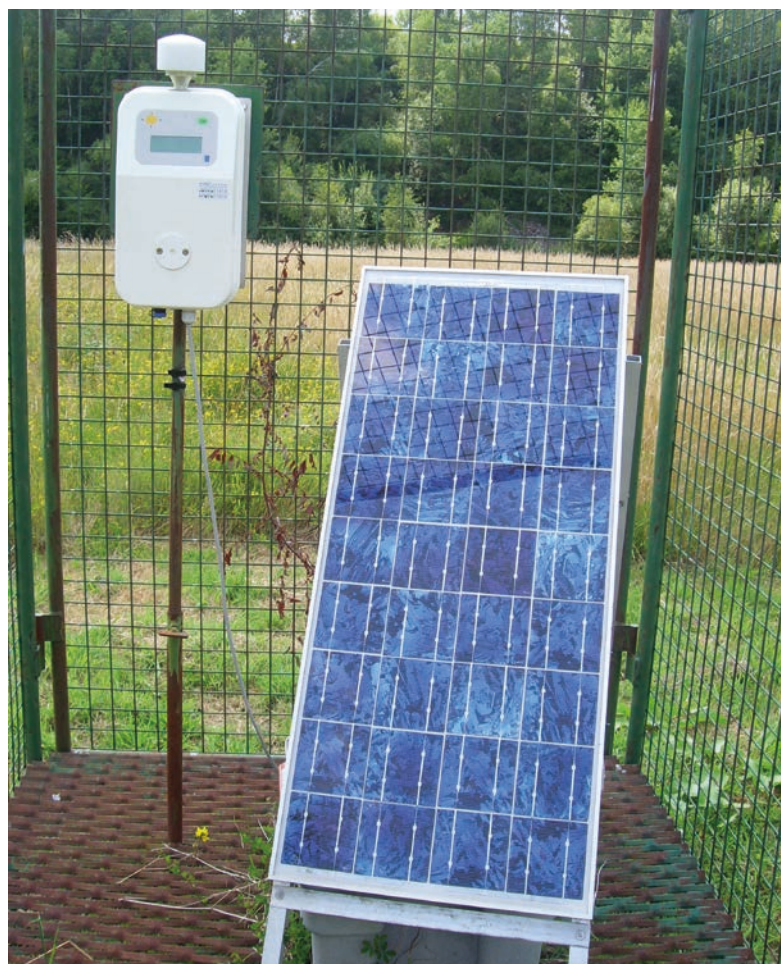
FIGURE 3 / DISPOSITIF DE MESURE DE L'ÉNERGIE ALPHA POTentielle
