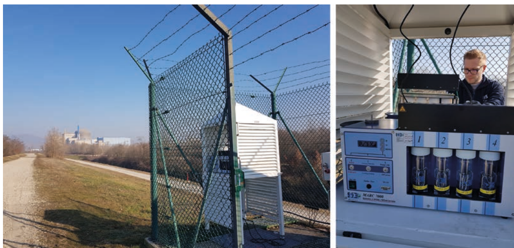
FIGURE 2 / INSTALLATION DU BARBOTEUR TRITIUM À 1 KM AU SUD DU CNPE DE SAINT-ALBAN
