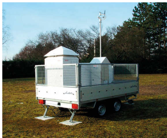
Station de collecte d'aérosols à grand débit ( 300 \text{ m}^3/\text{h} ) installée temporairement par l'IRSN dans l'environnement du site de Mange-Garri pour sa campagne de mesures.
