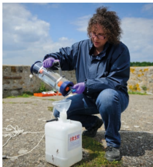
FIGURE 9 / ÉCHANTILLONNAGE PONCTUEL D'EAU À L'AIDE D'UN PRÉLEVEUR HORIZONTAL KEMMERER
