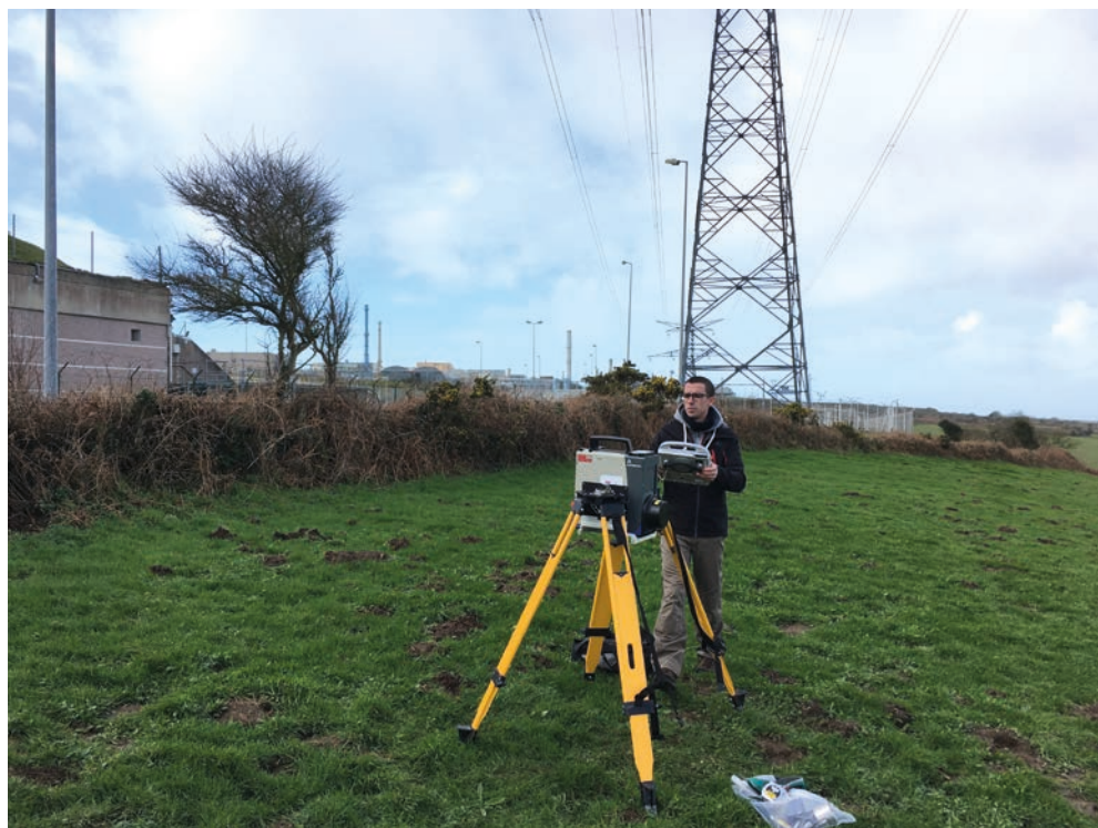
Mesure par spectrométrie gamma in situ réalisée par l'IRSN à proximité du site de La Hague suite à l'incendie de février 2020.
