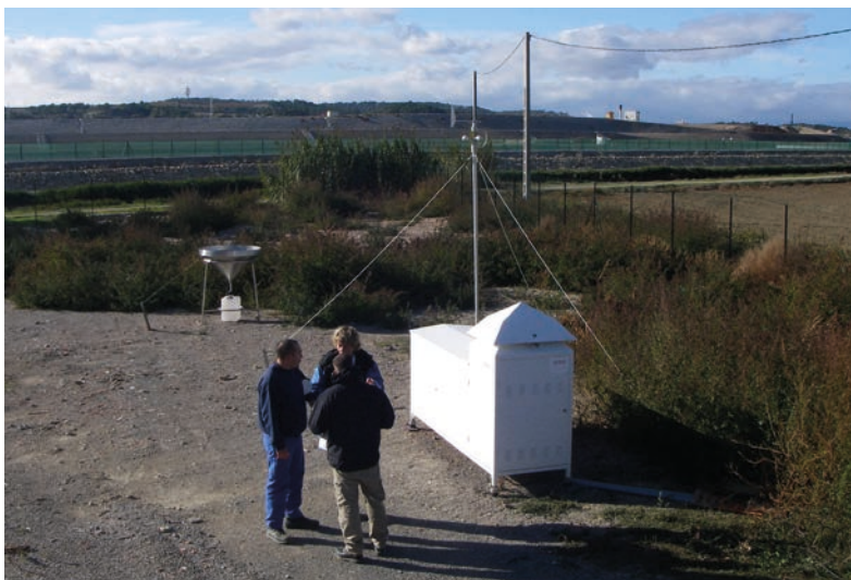
L'une des deux stations de prélèvement d'aérosols atmosphériques à grand débit, installée par l'IRSN sous les vents du site de Malvés pour la campagne de mesures débutée fin 2020. En fond d'image, les bassins d'évaporation et l'usine.
