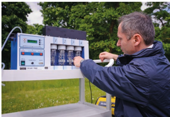
FIGURE 4 / BARBOTEURS POUR LE PRÉLÈVEMENT DU TRITIUM OU DU ^{14}\text{C} ATMOSPHÉRIQUE
