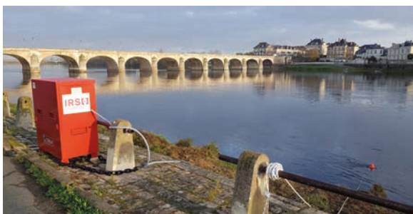
Hydrocollecteur en rive gauche
