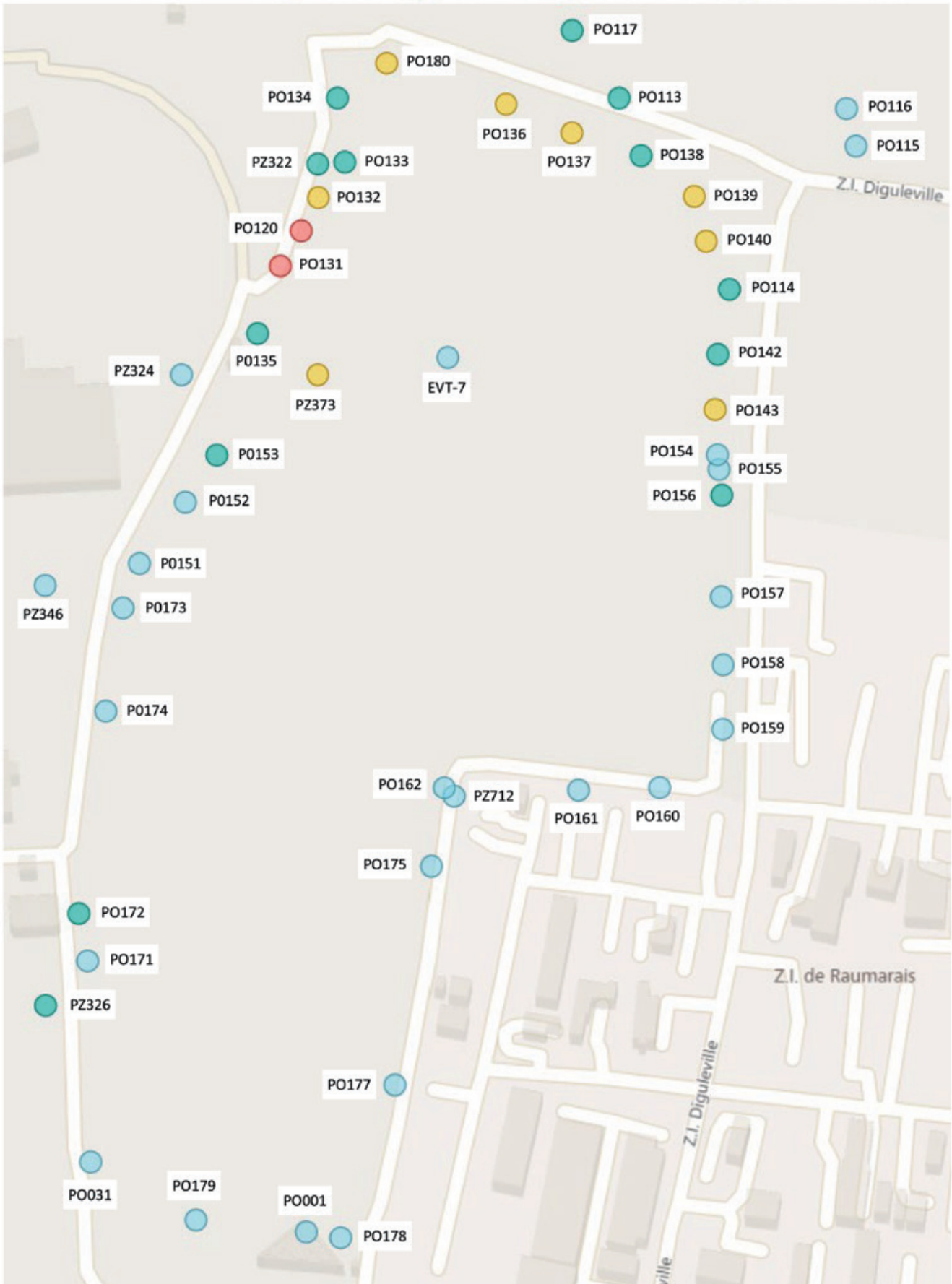
Figure 61 : Activité moyenne du tritium dans les eaux de nappe prélevées au niveau des différents piézomètres du CSM et de l'établissement Orano de la Hague sur la période 2016-2017 (source RNM)
