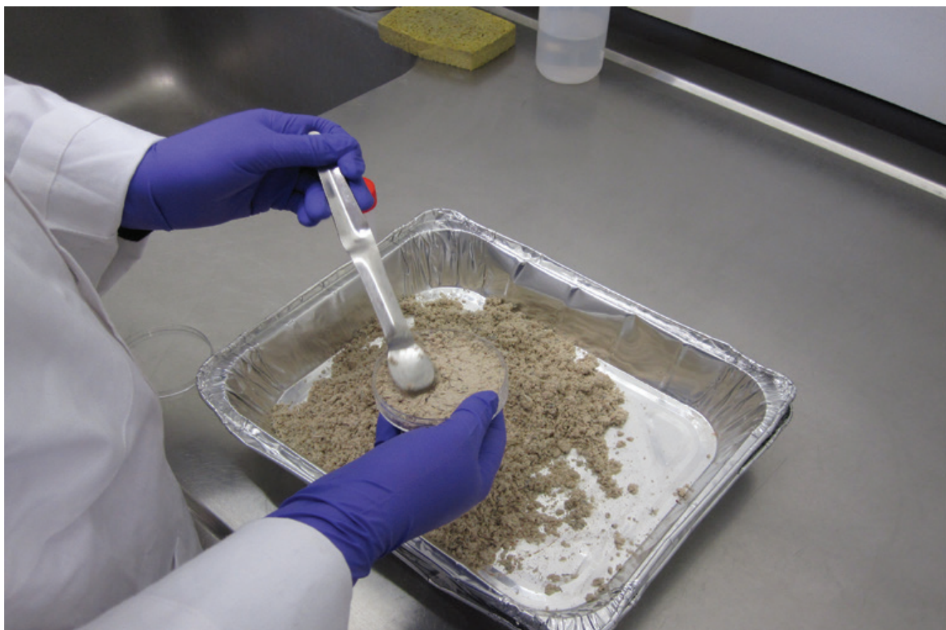
Mise en géométrie pour comptage par spectrométrie gamma dans les laboratoires de l'IRSN (octobre 2015) © Jean-Baptiste SAUNIER/IRSN
