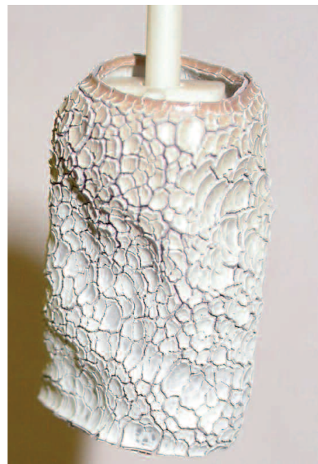
Figure : Échantillon de gaine Zry-4 après oxydation sous air à 950 °C pendant 80 mm.
