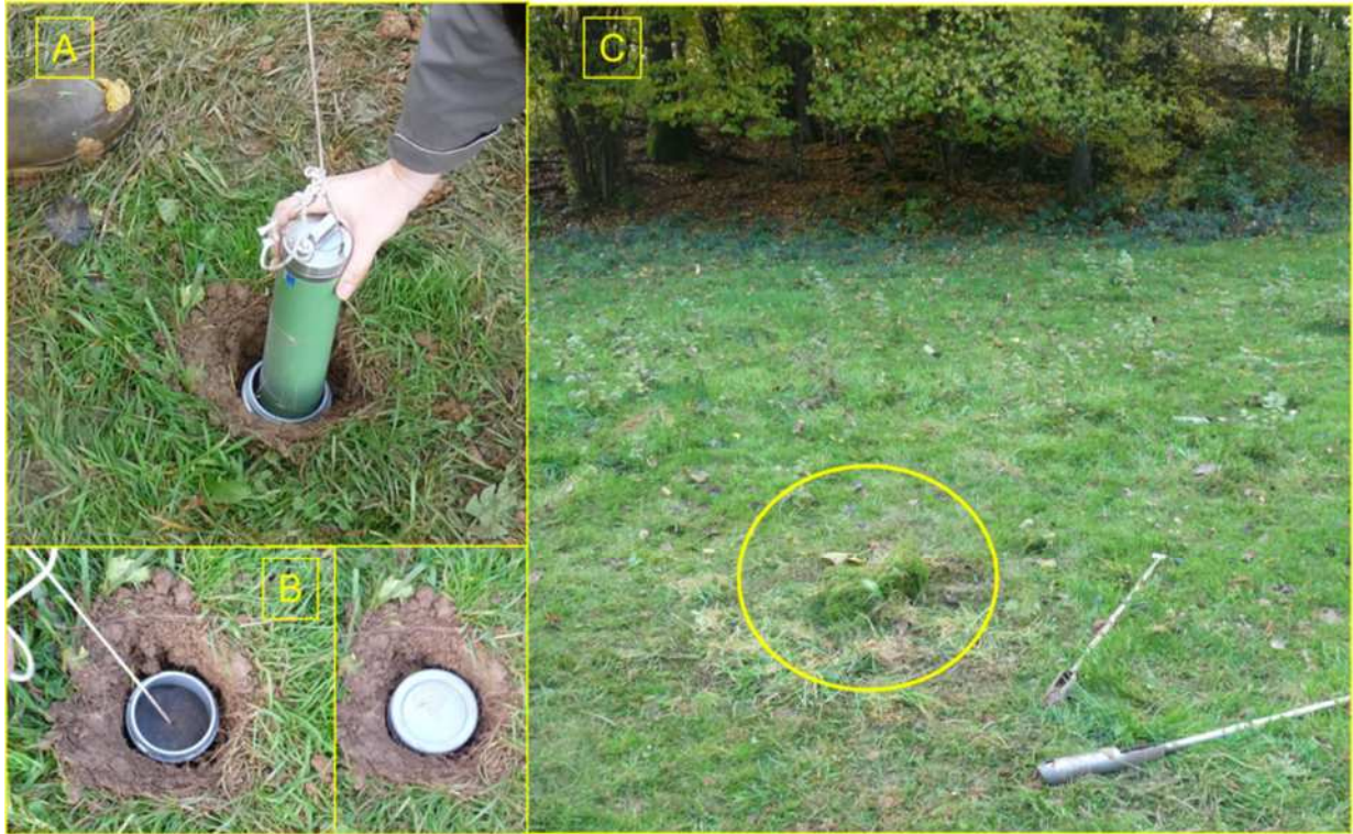
Figure A-4 – Mise en place d'une sonde BMC2 pour la mesure en continu de l'activité volumique du radon dans l'air du sol ; A : insertion de la sonde dans le tube PVC jusqu'à 1 m de profondeur ; B : étanchéification par la pose de deux bouchons ; C : Emplacement de la sonde après camouflage.
