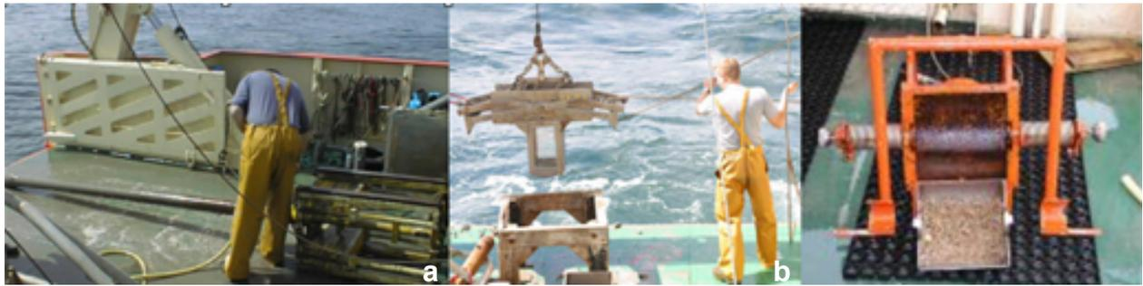
**Figure 3.7. Moyens de prélèvement à la mer utilisés durant la campagne DIAPLU : (a) carottier Kullenberg ; (b) benne Flusha ; (c) benne Shipec**
