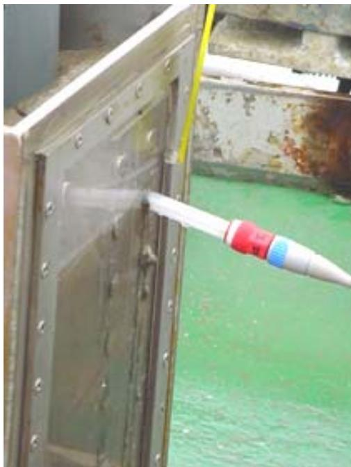
**Figure 3.11. Mesure de paramètres géochimiques des sédiments directement dans la boîte du carottier Flusha**
