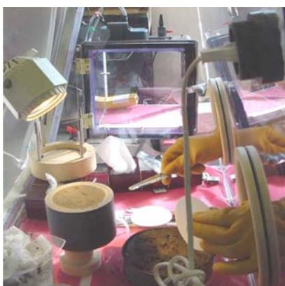
**Figure 3.9. Boîte à gants dédiée à l'extraction des sédiments depuis la carotte et au remplissage de la presse à sédiments**
