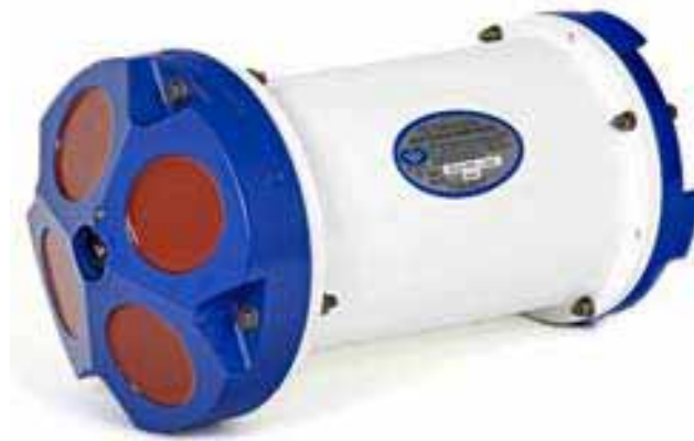
Figure 3.1 : Image d'un ADCP Workhorse Sentinel couché sur le flanc. La capsule bleue ornée de 4 facettes rouges représente la tête qui est tournée vers le haut lors des enregistrements du courant dans la colonne d'eau. Le corps blanc renferme la carte d'acquisition, la carte mémoire et la batterie.
