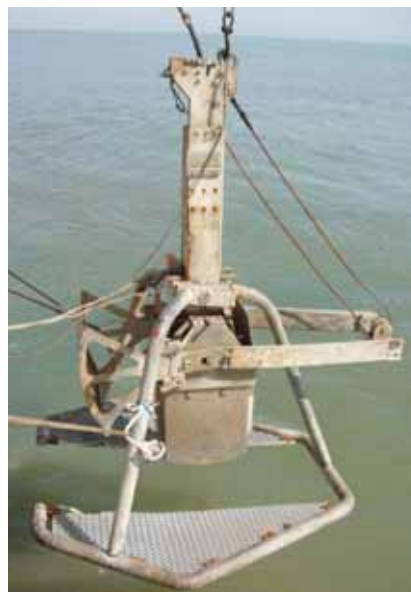
Figure 3.16 : Benne USNEL en phase d’immersion à l’embouchure du Rhône.
