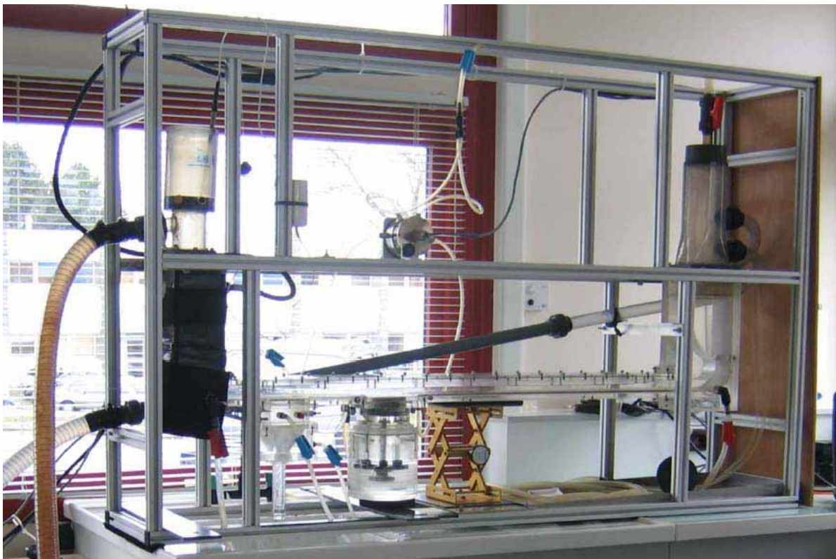
Figure 3.26 : Erodimètre d'IFREMER ou canal à courant transportable chargé de simuler l'action érosive d'un flux liquide d'intensité variable.
