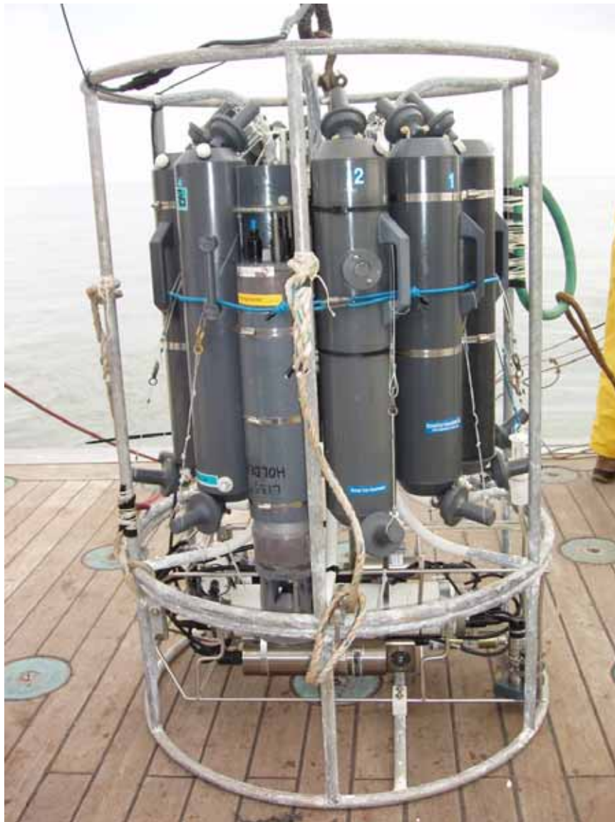
Figure 3.20 : Rosette de 11 bouteilles Niskin couplées au granulomètre laser in-situ (premier plan entre les bouteilles), à la sonde CTD (en bas du cylindre), au transmissomètre et aux sondes NKE (derrière la CTD).
