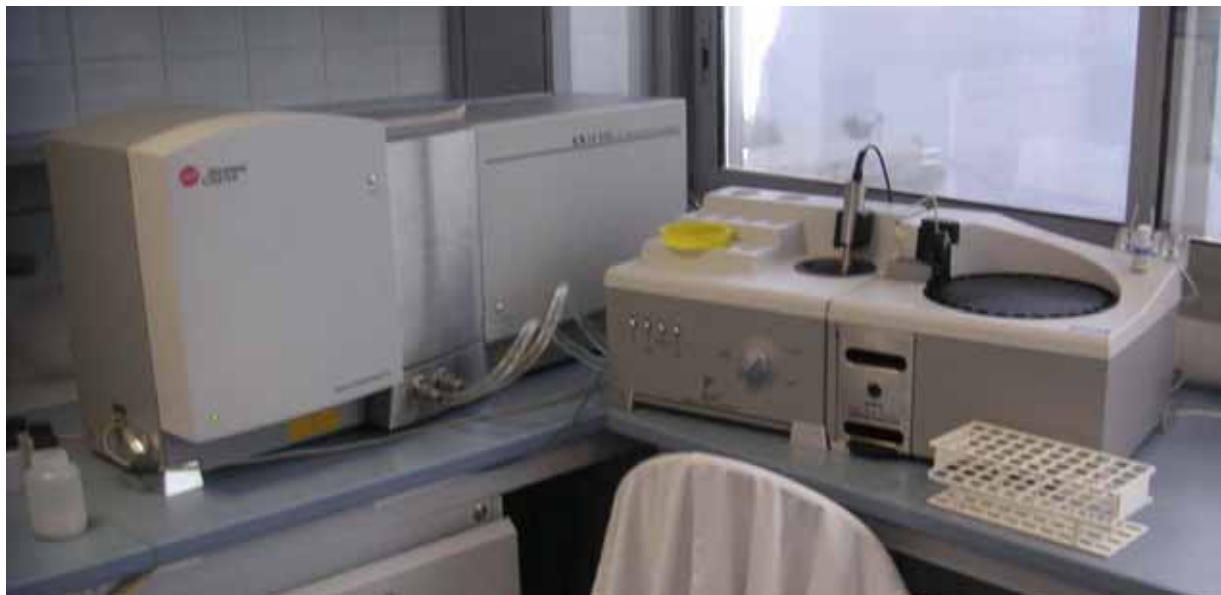
Figure 3.28 : Granulomètre à diffraction laser Beckman & Coulter LS 13320 avec son banc optique, son module d'échantillonnage et son passeur d'échantillons.
