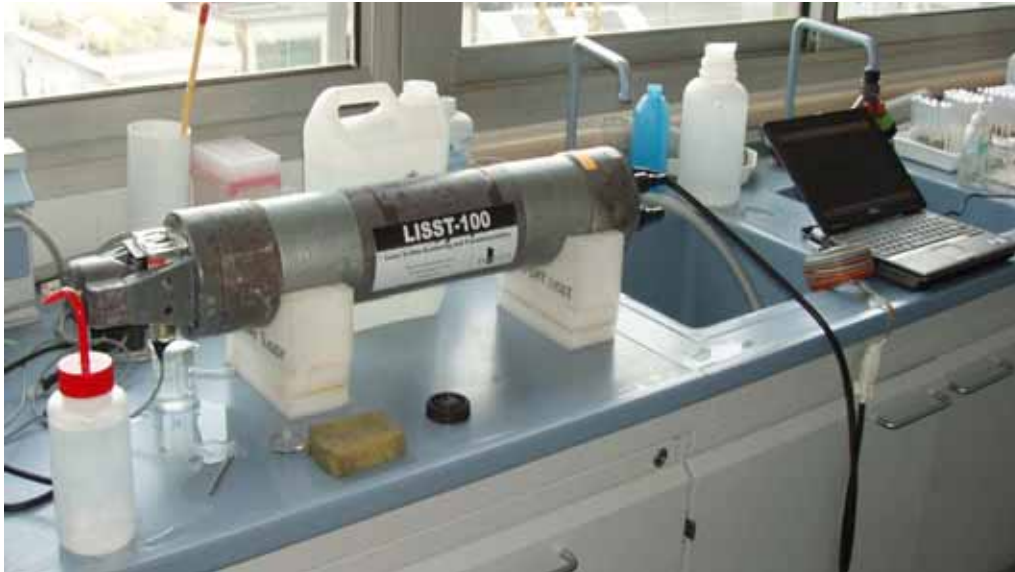
Figure 3.29 : Granulomètre laser in situ LISST 100-X utilisé en laboratoire avec sa cuve et relié au logiciel Sequoia.
