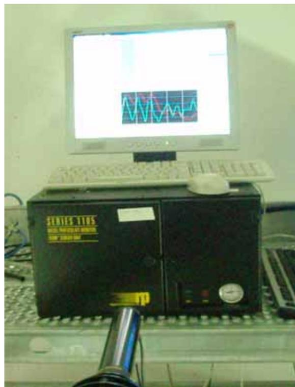
Figure 5.6 : Impacteur Andersen (gauche) et équipement de la balance TEOM (droite) utilisés pour la caractérisation des aérosols émis lors de la combustion du bois.
