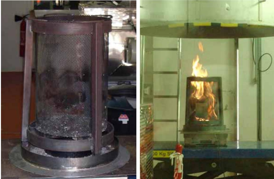
Figure 5.7 : Panier métallique accueillant le combustible bois (gauche) et vue du panier placé sur la plateforme à la verticale de la hotte de prélèvement des émissions lors de la phase de combustion (droite).
