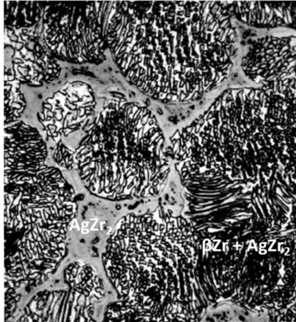
Figure 7 : Métallographie optique x750 réalisée par (Kemper 1952) après attaque chimique : échantillon Ag-Zr contenant 86,1 at.% Zr.
