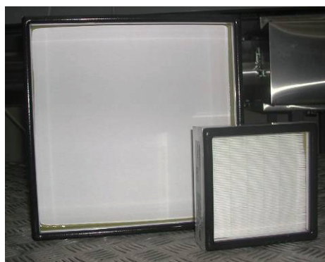
Figure 2–21 : Photographie d'un filtre THE plan (à gauche) et d'un filtre THE plissé (à droite) étudiés durant ces travaux
