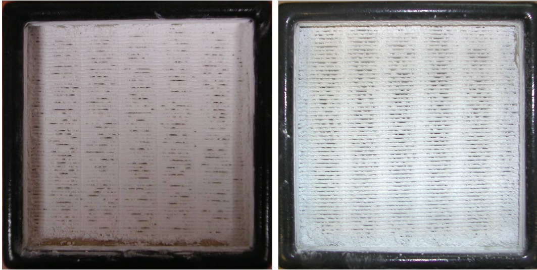
Figure 3–28 : Photographies de la surface de deux filtres plissés après un colmatage jusqu'à 240 \text{ g.m}^{-2} de particules d'alumine, à 5 % d'humidité relative et à deux vitesses de filtration : à gauche de 1,2 \text{ cm.s}^{-1} et à droite de 2,6 \text{ cm.s}^{-1}
