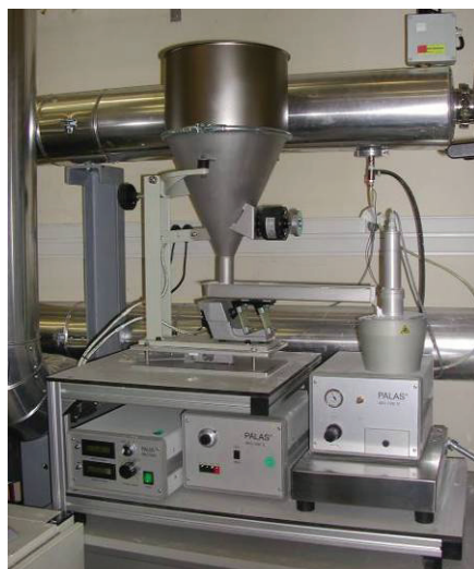
Figure 2-8 : Générateur par dispersion de poudre PALAS BEG-1000
