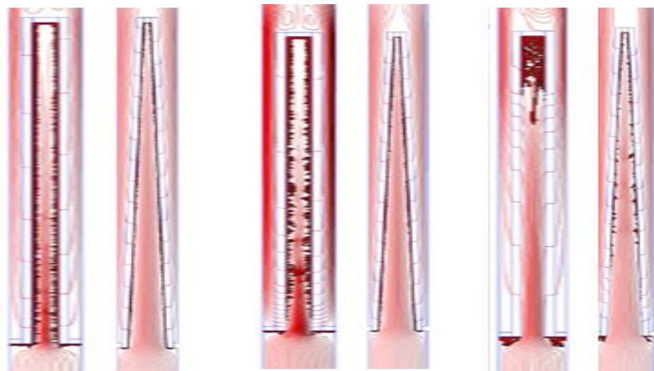
Figure 25 : Résultats des simulations CFD pour, de droite à gauche : des aérosols de 3 \mu\text{m} et une vitesse de 20 \text{ cm/s} , des aérosols de 10 \mu\text{m} et une vitesse de 20 \text{ cm/s} et des aérosols de 10 \mu\text{m} et une vitesse de 1 \text{ m/s} . On note également l'influence du type de plis (Fotovati et al. 2011).
