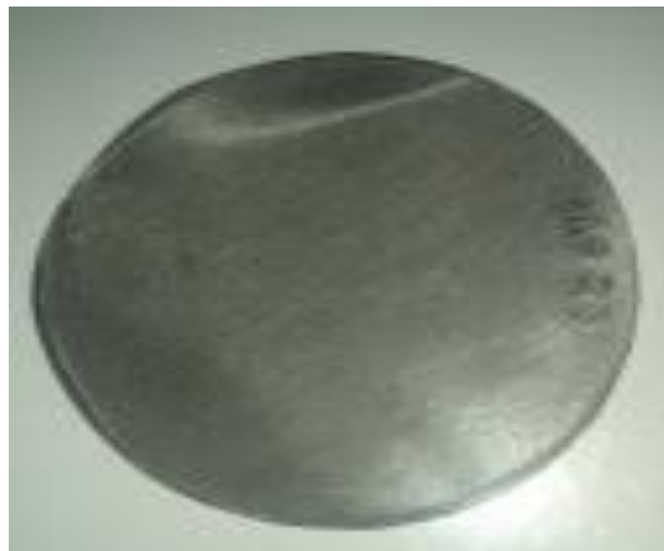
Figure 2.3 : Grille de diffusion (TSI ; Model 376060) utilisée pour le prélèvement de la fraction libre des descendants du ^{222}\text{Rn} .
