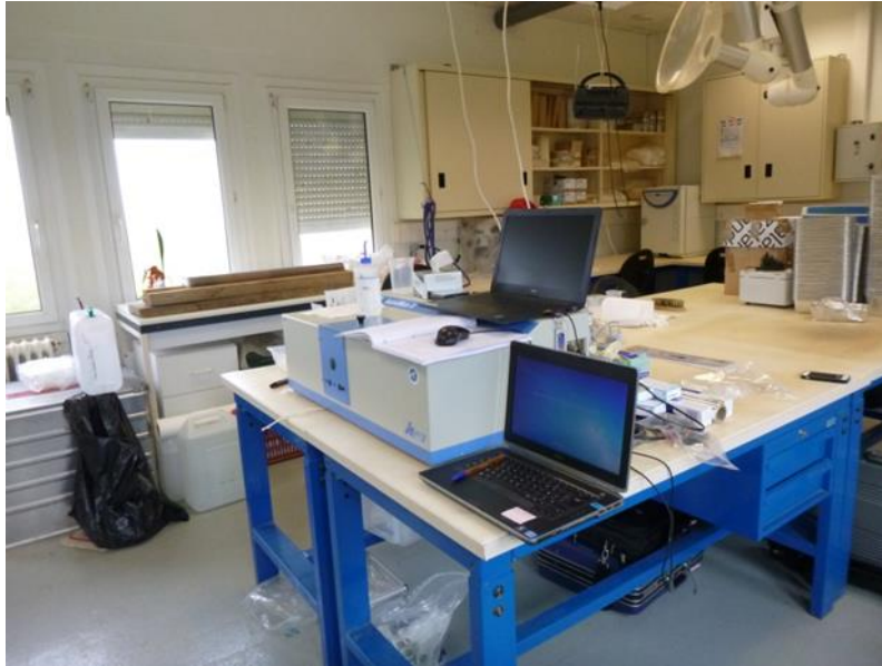
Figure 2.19 : Mesure de la concentration en fluorescéine par spectrofluorimétrie.
