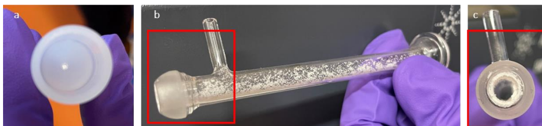
Figure 44. Dépôts de NTA en sortie du désolvateur (a) et dans le tube de transfert vers la torche à plasma (b) (c) après passage des 8 échantillons.
