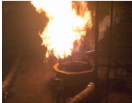
Figure 3. Photographie de la combustion d'un feu de nappe en régime sous-ventilé. © IRSN.
