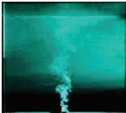
Figure 43. Illustration du remplissage d'un local par un panache (expérimentation à échelle réduite avec une similitude air/hélium) [27].
