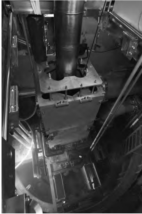
Figure 39.4. Vue de dessus du cœur du réacteur CABRI dans la piscine d'eau et de la boucle d'essais (alors en sodium) qui le traverse verticalement. G. Lesénéchal/CEA.
