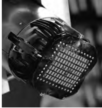
Figure 27.1. Un prototype de sonde multi-éléments, «conformable», à ultrasons – brevet IRSN/CEA. IRSN/CEA.
