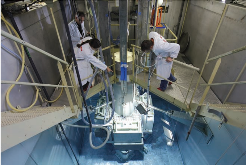
Figure 5.4. La piscine de MINERVE. Chargement d'un échantillon dans la cavité centrale pour la mesure d'effet en réactivité par la méthode dite d'oscillation. © G. Lesénéchal/CEA.
