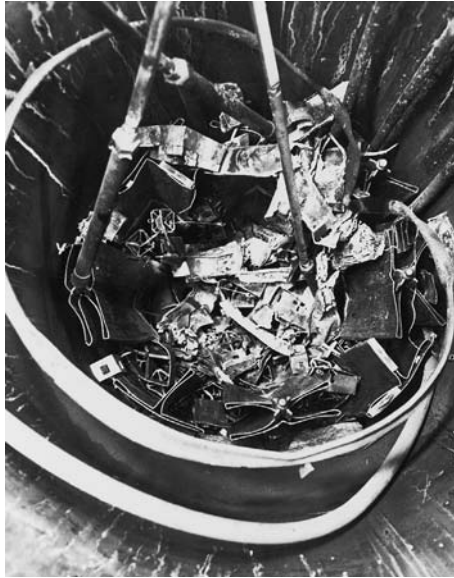
Figure 8.1. Vue du cœur du réacteur SL-1 après l'accident de réactivité survenu en 1961 ; trois des mécanismes de barres sont visibles. © INL.
